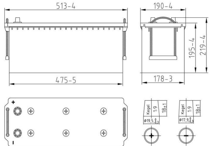
Bei Ruhespannung  $\leq 12,5$  V: Batterie nachladen
