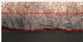
Corrosion Layer ~ 300µm
