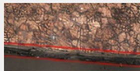
Corrosion Layer ~ 100µm
